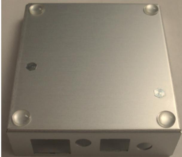
Montieren Sie das ERC-M-Interface mit den M3x6 Schrauben in das Gehäuseunterteil.
